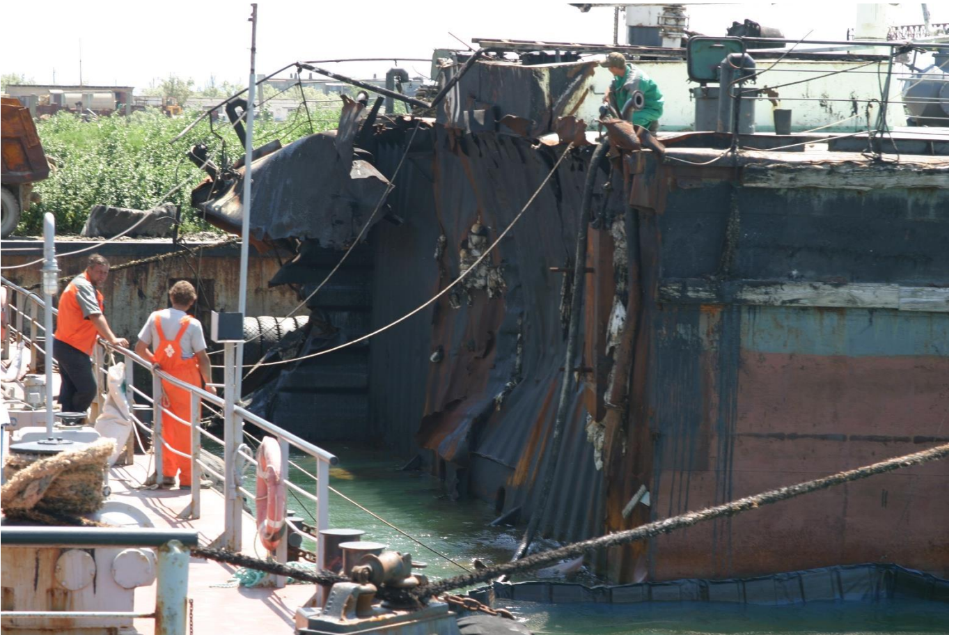
Рис. 5. Место разлома корпуса танкера «ВОЛГОНЕФТЬ-139»
