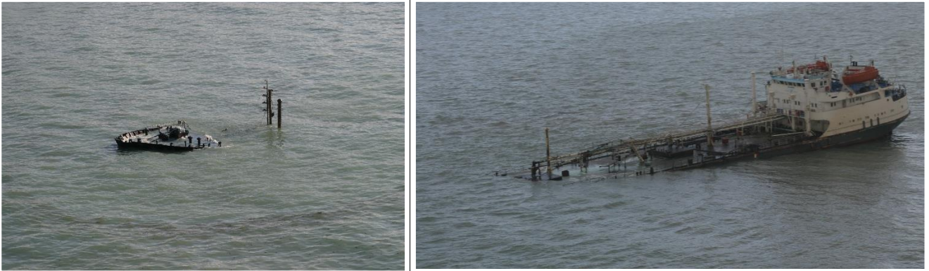
Рис. 4. Носовая и кормовая части после разлома танкера «ВОЛГОНЕФТЬ 139»
